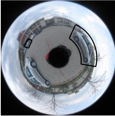
Şekil 6: Tümyönlü imgede kameraya farklı uzaklıkta bulunan ve siyah çerçeve ile gösterilen iki araçtan, büyük olan daha bükülmüş bir pencere ile aranmalı, küçük olan ise daha düz bir pencere ile aranmalıdır.
