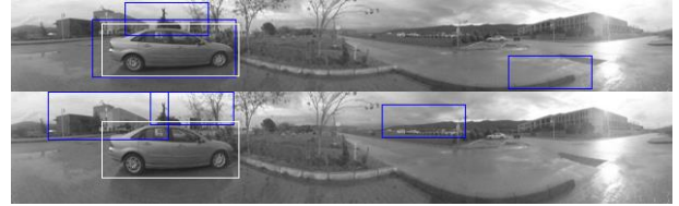
Şekil 11: Eşik değeri, en yüksek skorlu üç pencere geçecek şekilde ayarlandığında; küresel kesitli (üstte) ve silindirik (altta) panoramik imgelerin test sonuçları (koyu renkli çerçeve) ve etiketlenen araç (beyaz çerçeve).
