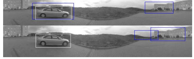
Şekil 10: Eşik değeri, en yüksek skorlu iki pencere geçecek şekilde ayarlandığında; küresel kesitli (üstte) ve silindirik (altta) panoramik imgelerin test sonuçları (koyu renkli çerçeve) ve etiketlenen araç (beyaz çerçeve).
