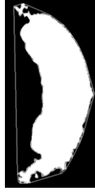
Şekil 3. Bir dolmuş örneğine ait silüet. Dışbükeylik 0.73'tür. Bu da eşik değeri olan 0.75'in altındadır.
